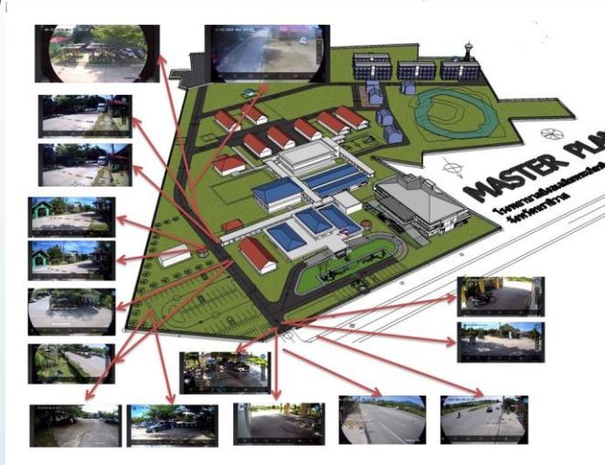
ระบบกล้องวงจรปิดภายนอกและภายใน โรงพยาบาล
